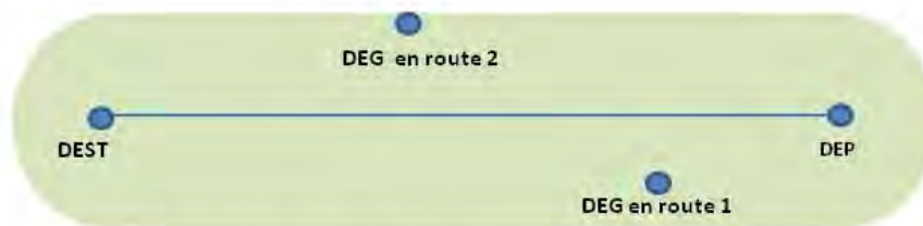
Exemple de route étroite avec dégagement en route (cas d'un vol en VFR)
